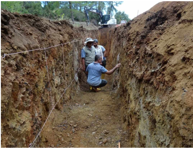
Şekil 3. Aktif tektonik araştırmalarında yerbilimcilerin baş vurduğu paleosismolojik amaçlı hendek çalışmaları, aktif bir fayın geçmişte oluşturduğu depremlere ait izlerin araştırılmasını konu edinmektedir.
