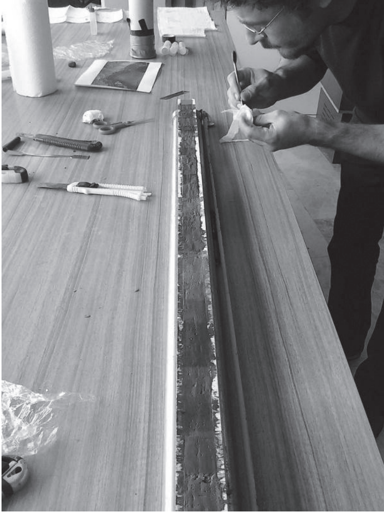
Şekil 4 Muğla Sıtkı Koçman Üniversitesi laboratuvarında gerçekleştirilen yapay karot oluşturma işlemi.
