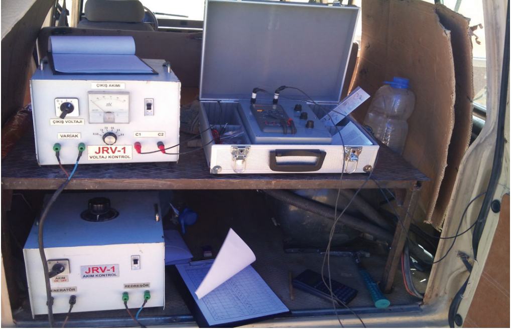
Şekil.7. KJA'da Jeoson Jeoloji Sondaj Şirketine Ait Jeofizik Aletlerle Kazan da DES Ölçüsü
