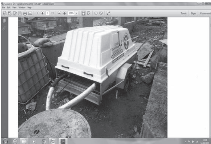
Şekil 3.3 Toprak Isıl Duyarlılık Test cihazına ait görüntü.
