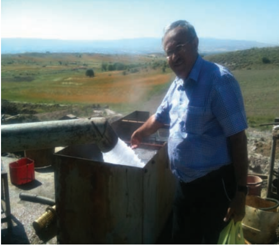
Şekil.11. KJA'da İKJ 5 nolu Sondaj da dik milli pompa yardımıyla su tecrübe çalışmaları yapıp su örneklerin alınması
