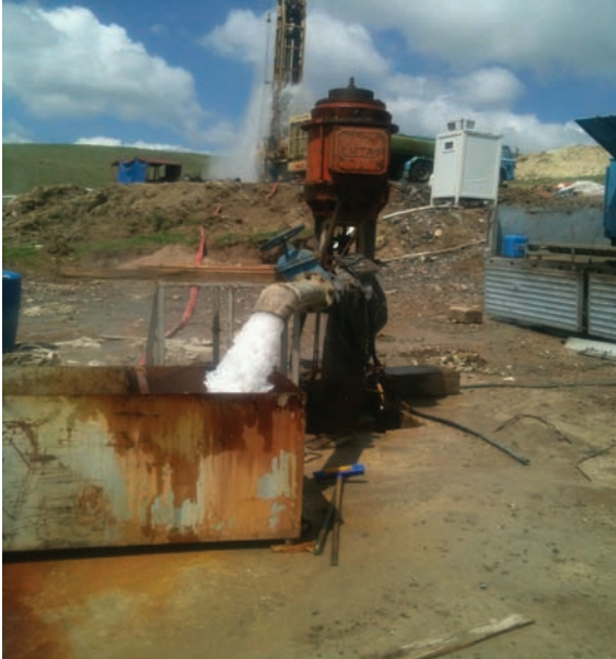
Şekil.12. KJA'da İKJ 3 nolu Sondaj da pompa testi çalışmaları ve arkada İKJ5 nolu Sondaj da hava ile inkişaf yapılırken kuyular biri birini etkilememektedir
