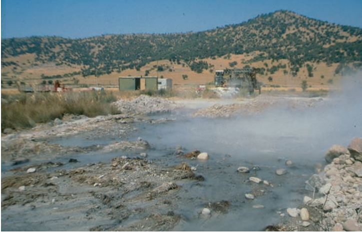
Foto. 4. Dikili Kaynarca – 1 kuyusu. Soğuksu sondajcısı ben bilirim düşüncesi ile ilk yapmış olduğu 29m lik kuyu kontrolsüz üretime geçmiş ve şirket tüm sondaj avadanlıklarını ve 2 aylık faaliyet ücret ve gelirini buraya gömmüştür.
