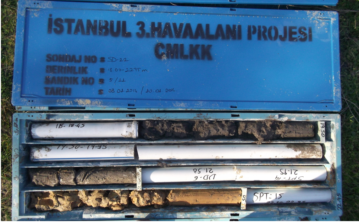
Foto 3. Havaalanı sahasında yapılan sondaj çalışmalarından elde edilen zemin karot sandık fotoğrafı, (Göllere yakın alt kotta yapılan sondaj çalışması, 18,00-23,00 m arası)
