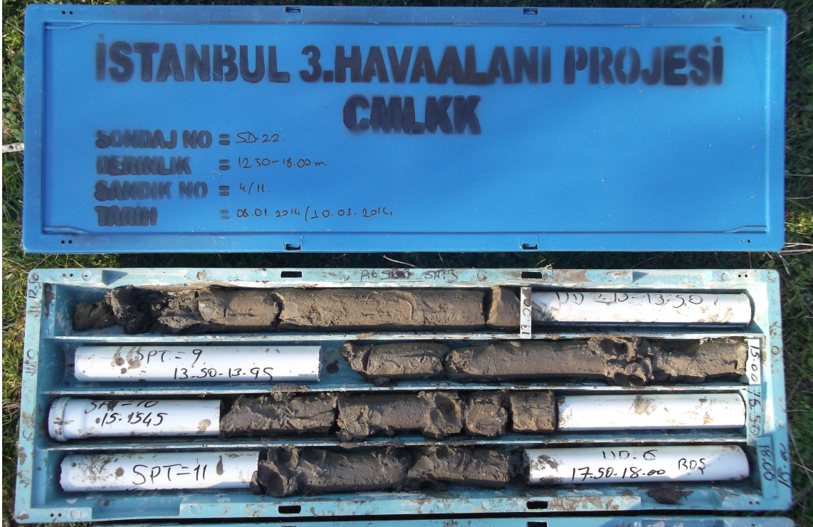
Foto 2. Havaalanı sahasında yapılan sondaj çalışmalarından elde edilen zemin karot sandık fotoğrafı, (Göllere yakın alt kotta yapılan sondaj çalışması, 12,50-18,00 m arası)
