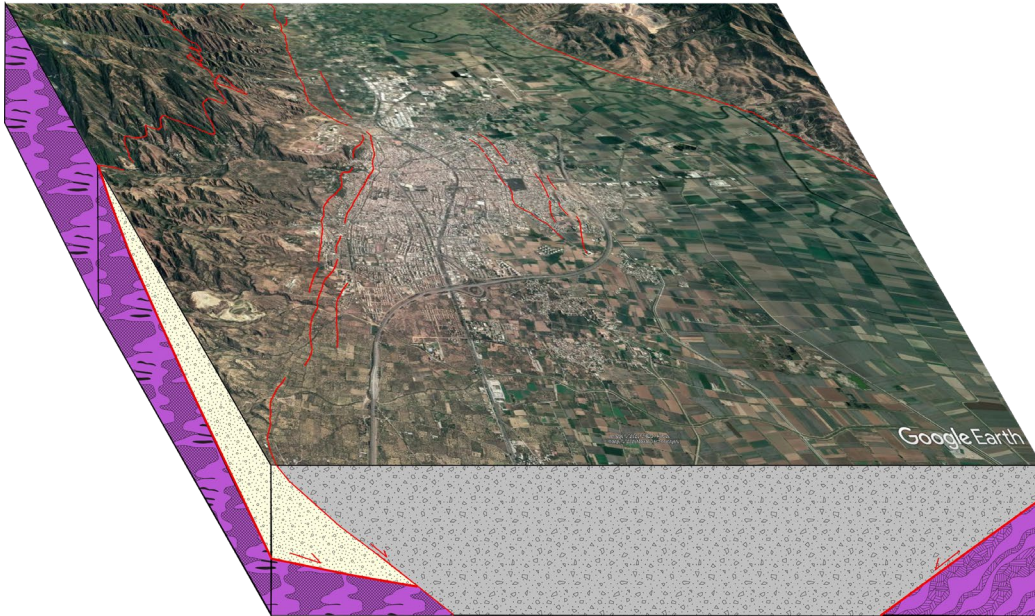
Şekil 5- Aydın'ın genel yeraltı yapısı. Kırmızı çizgiler diri fayları, mor alanlar kaya türü zeminleri noktalı sarı ve gri alanlar eski ve yeni alüvyonları göstermektedir.
