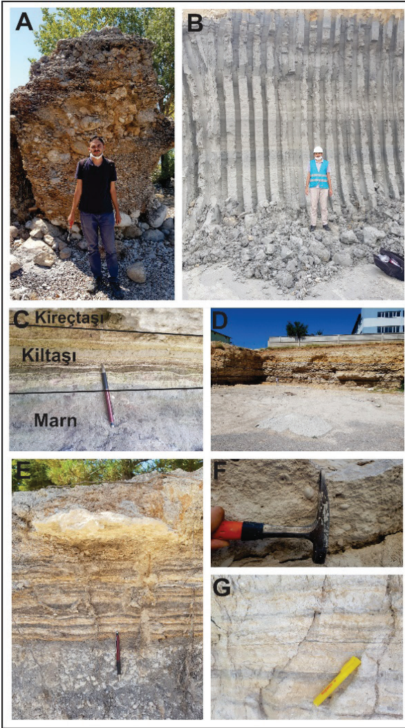
Şekil 4. A) Karadiken'nin kuzeybatısındaki konglomera (Bakış Yönü: D'dan B'ya doğru). B) Kömür Ocağı lokasyonu kiltası seviyesi (Bakış Yönü: KD'dan GB'ya doğru). C) Göçü mevkiindeki organikçe zengin marn, kiltası, kireçtaşı seviyesi (Bakış yönü: KD'dan GB'ya doğru). D) Beyşehir Sanayii ölçülü stratigrafik kesitindeki organikçe zengin marn-kireçtaşı arıdanması (Bakış Yönü: KD'dan GB'ya doğru). E) Beyşehir lokasyonunda açık koyu renkli arıdanmalı laminalı kiltası (Bakış Yönü: GD'dan KB'ya doğru). F) Yenidoğan mevkiindeki bol fosilli kireçtaşı G) Küçükafşar lokasyonuna ait açık-koyu renkli marn arıdanması (Bakış Yönü: GB'dan KD'ya doğru).
