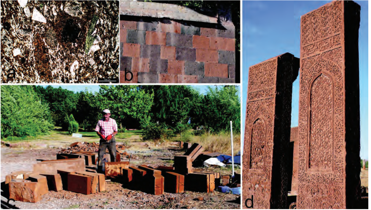
Şekil 2. Ahlat Taşı; a. İnce kesitteki görünüşü. Tipik ignimbrit dokusu dikkat çeker, b. Tarihi bir yapıda gri ve kırmızı renkli Ahlat Taşı'nın birlikte kullanımı, c. Ocaktan yeni getirilmiş ve testere ile kesilen kırmızı Ahlat Taşı blokları, d. Ahlat Taşı'ndan mezartaşları.
