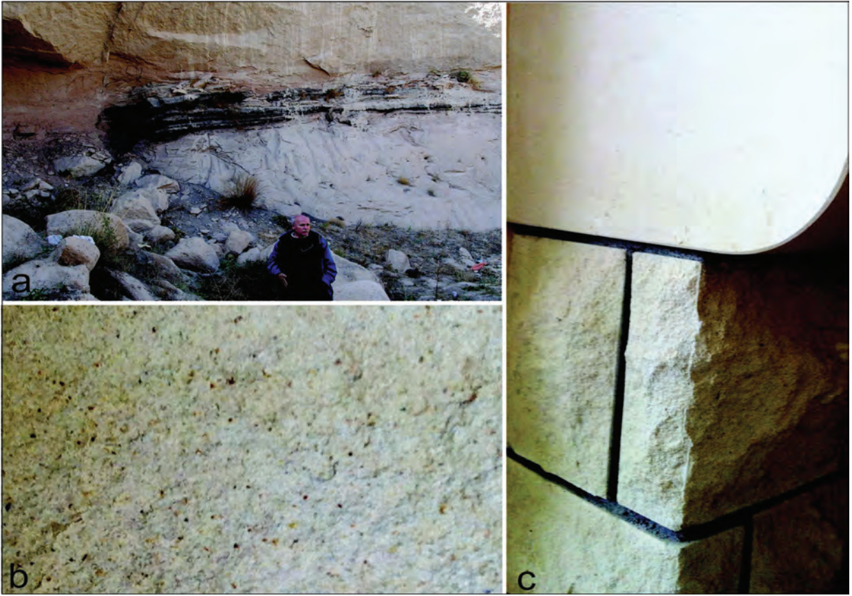
Şekil 5. Nevşehir Taşı; a. Bu taşın üretildiği Kavak İgnimbitinin saha görüntüsü, b. Nevşehir Taşı’nın el örneğindeki ince taneli dokusu, c. Parlatılmış (üstte) ve doğal haldeki (altta) tipik Nevşehir Taşı örnekleri.
