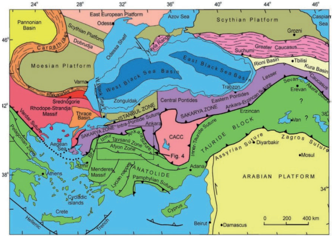
Şekil 1. Türkiye ve yakın çevresinin ana kenet ve kıtasal levhaları gösteren tektonik harita (Okay ve Whitney, 2010). İçi dolu üçgenlerle gösterilen kalın çizgiler eski dalma-batma zonlarının yönünü (polarite) ve suture kuşaklarını, içi boş üçgenli kalın çizgiler ise aktif dalma-batma zonlarını temsil eder. BFZ: Bornova Fliş Zonu; CACC: Orta Anadolu Kristalin Kompleksi (Kırşehir Masifi).
