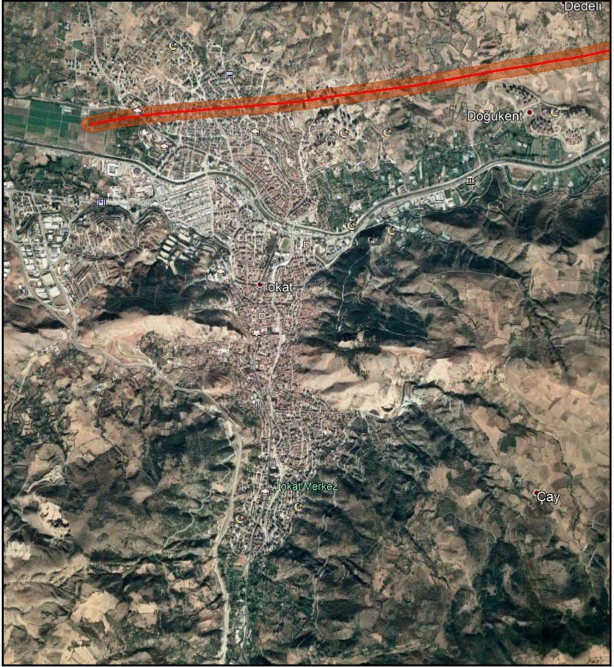
Şekil 4. Türkiye Diri Fay Haritasına göre Tokat kent merkezinden geçen diri faylar. Yerlerinin hassas olarak bilinmemesi nedeniyle faylar 100 m kalınlığında şeritler olarak gösterilmişlerdir. Yapılacak araştırmalar ile fay yerlerinin hassas olarak belirlenmesi gerekmektedir.
