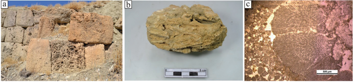
Şekil 13. a, b) Çavuştepe Aşağı Kale güney sur duvarı ve buradan alınan traverten kayaç örneğinin makro görüntüsü. c) Aynı yere ait başka bloktan alınmış kireçtaşı kayacına ait örneğin polarizan mikroskop görüntüsü ve kesit içinde görülen denizel alg fosili.
