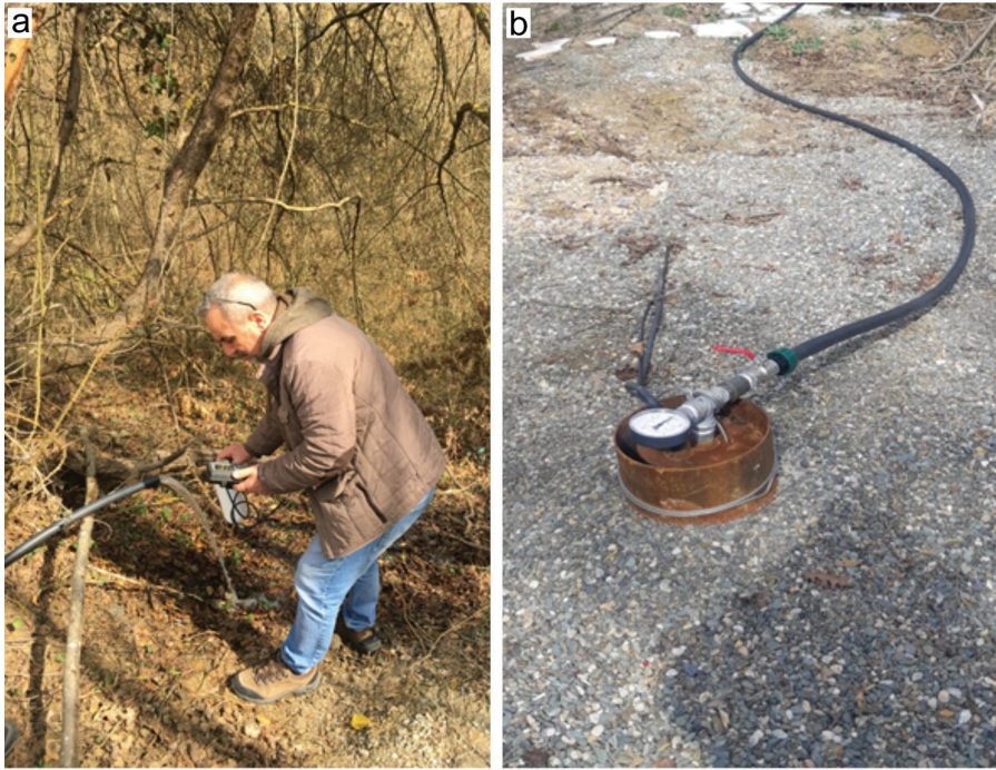
Şekil 1. a) Çaybaşı maden suyu. Kaynaktan üretim sığ bir kuyu vasıtasıyla yapılmaktadır, b) İnegöl maden suyu kaynağına ait kuyubaşı manometresi
