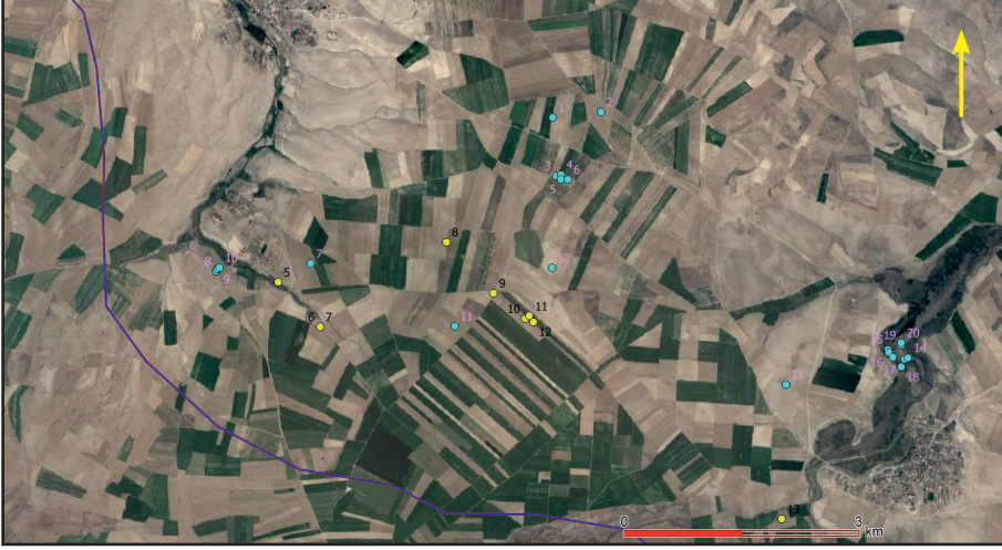
Şekil 12. Uydu görüntüleri yardımı ile saptanmaya çalışılan obruk oluşum yerleri
