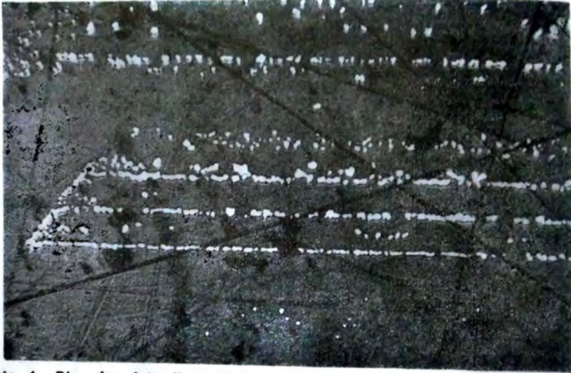
Photo 1. Die den kristallographischen Richtungen (III) parallel angeordneten Kupferkiesentmischungstropfen in früh kristallisierten Kernpartien der grossen Zinkblendekristalle, 140X, öl, N//.
