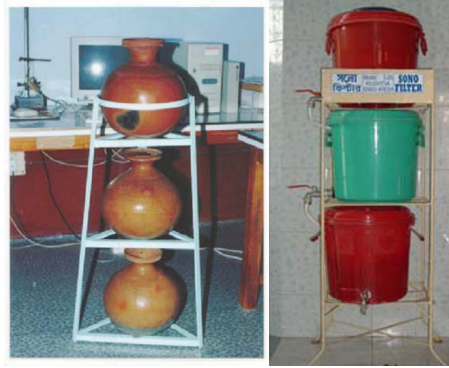
Şekil 5. Sono 3 Kolshi filtresinden bir görünüm.
