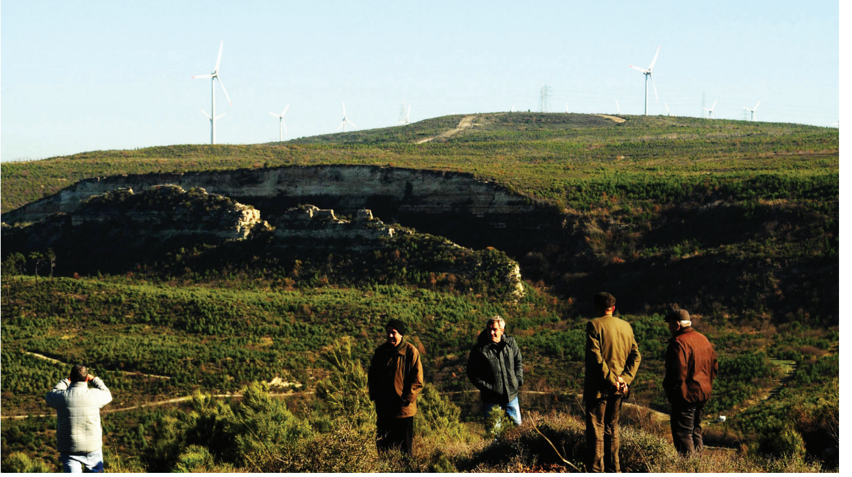
Şekil 9. Taç kırığı 535m uzunluğunda olan heyelanın yüksek açılı aynası ve baş kısmı görülmektedir. Şekilde görülen kireçtaşı bloğunun genişliği 385 m'dir. Lokasyon için Şekil 6 ve 7'ye bakınız.
