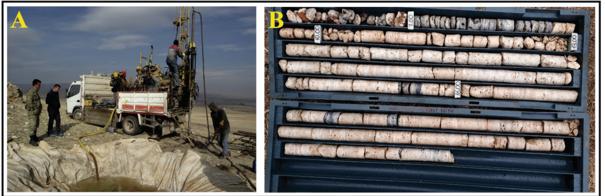
Şekil 3. A) Travertenlerde yapılan karotlu sondaj çalışması ve (B) karot sandıklarından birinin görünümü.
