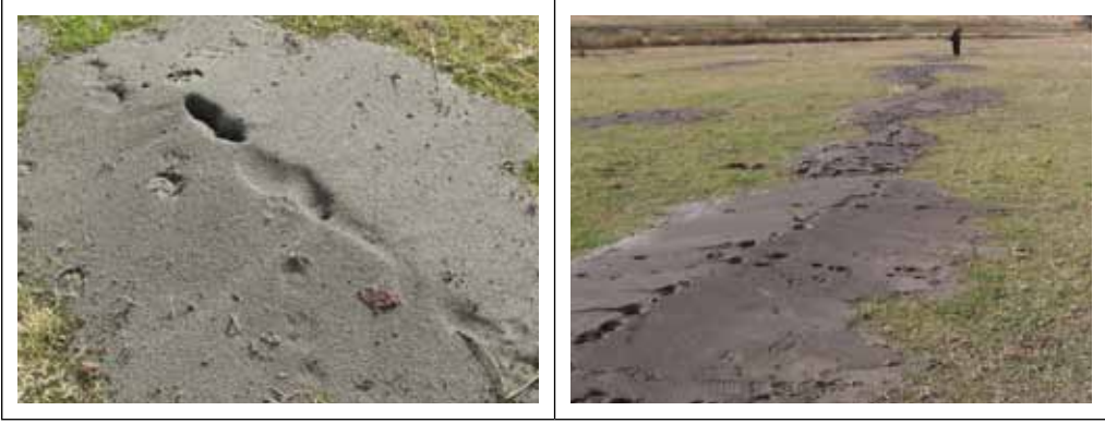
Şekil 13. Topaktaş-Arisu-Dibekdüzü çevresinde gelişen sıvılaşma yapılarına ait arazi fotoğrafları. Soldaki fotoğrafta çizgisel çıkış merkezli tipik bir kum konisi, sağdaki fotoğrafta ise çizgisel çıkış merkezli kum konilerinin belli doğrultularda onlarca metre uzanım sunduğunu gösterir.
