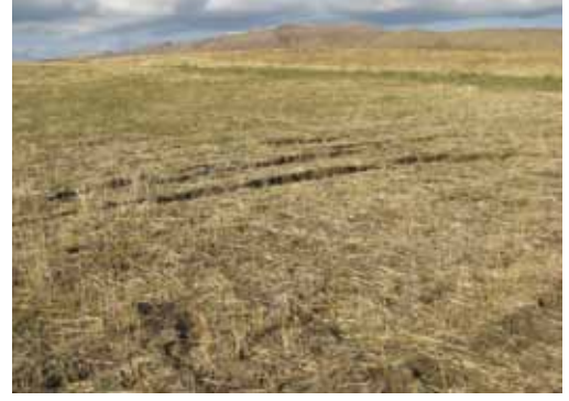
Şekil 27. Van Merkez Alaköy arazilerinde görülen sıvılaşma (A) ve oturma yapılarına (B) örnekler.
