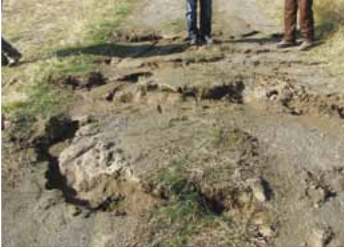
Şekil 27. Van Merkez Alaköy arazilerinde görülen sıvılaşma (A) ve oturma yapılarına (B) örnekler.
